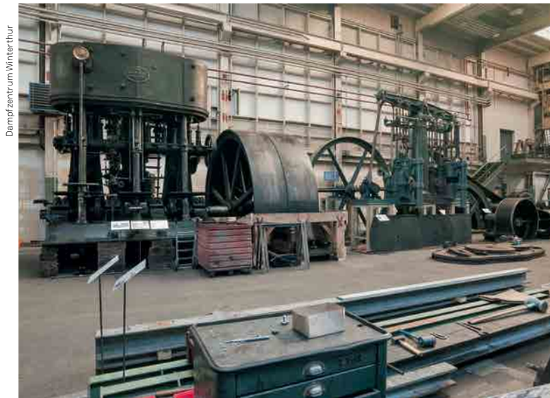
Die Drei-Zylinder-Verbundmaschine von Sulzer
