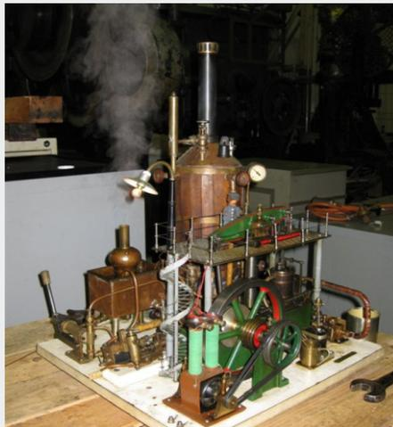
**Modell-Dampfmaschine mit Generator**
