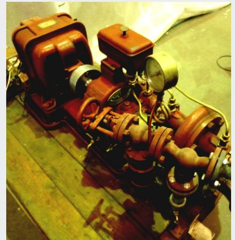
**Dampfdynamo für Schiffsbeleuchtung**
