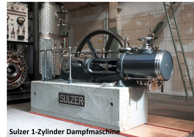
Sulzer 1-Zylinder Dampfmaschine
