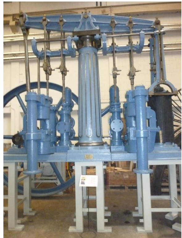
Balancier-Dampfmaschine mit Elektroantrieb, ein Schwerpunkt im Dampfzentrum Winterthur
