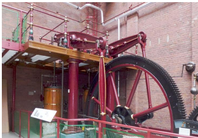
Eine wunderschöne Doppelbalancier-Dampfmaschine. Balanciermaschinen sind in England relativ häufig und oft mehrere Stockwerke hoch.
