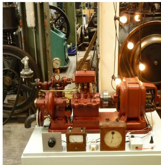
*Dampfdynamo mit der Laval – Turbine 1889 aus dem Dampfschiff „Giessbach III“, Brienzersee*
