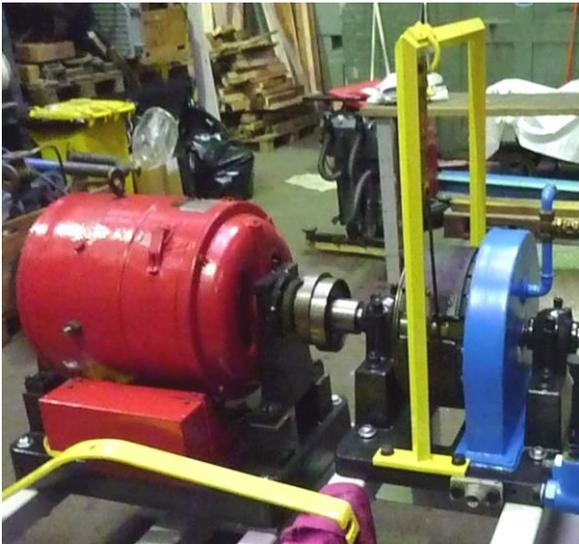
*Pendelgenerator Oerlikon rot, Bremsdynamometer blau*
