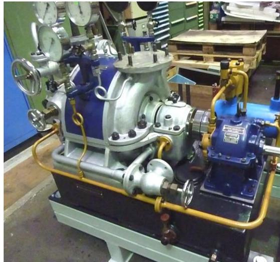
Restaurierte BBC Turbine mit Getriebe aus dem Technikum Biel, Brown Boveri 1932
