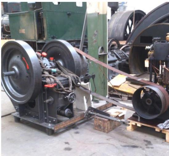
1-Zylinder-Dampfmaschine treibt Steinbrecher an Edward King, Zürich 1920
