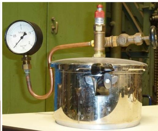
Vom Papinschen Topf zum Dampfkochtopf. Die Bilder zeigen einen Stich aus dem 17. Jh. (Quelle: Wikipedia), den Nachbau des Papinschen Topfes und einen neueren Dampfkochtopf, an dem das Funktionieren des Sicherheitsventil demonstriert werden kann (beides Objekte des Dampfzentrums).
