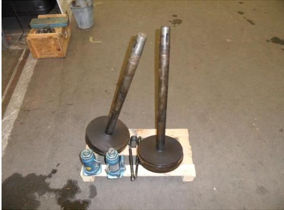
Die Kolben kamen in unversehrtm Zustand ans Tageslicht. Selbst die Kolbenringe waren nach dieser langen Zeit nicht in ihren Nuten verklebt. Auf der Drehbank spannten wir die Muttern auf der Vorderseite der Kolben ins Dreiba-ckenfutter und nahmen das Stangenende auf die Spitze, um mit Schmirgeltuch die Kolbenstangen wieder einiger-massen blank zu kriegen.
