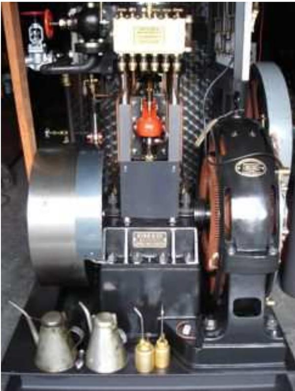
betriebsbereit aufarbeiten. Er ist das älteste Exponat der Sammlung aus Schweizer Produktion. Gleichzeitig konnte von der Käserei in Rüeggisberg ein für den Betrieb dieser Dampfmaschine geeigneter Kessel übernommen werden. Wasserpumpe und Beleuchtungstableau vervollständigen diese prächtige Betriebs-einheit. Die 1-Zylinder-Dampfmaschine von King leistet
