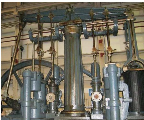
*Audrey Hepburn für Ingenieure: Mitte des 19. Jahrhunderts baute man Maschinen für die Ewigkeit. Daher baute man sie schön. Die griechische Säule ist der Angelpunkt zwischen stehendem Zylinder (rechts) und dem Schwungrad (links). Dazwischen finden sich je zwei Wasser- und Nassluftpumpen.*
