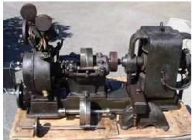
Der *Dampfmaschine de Laval* lieferte den Strom für die Beleuchtung auf dem Thunersee Dampfschiff "Bubenberg" oder "Helvetia". Auf welchem der beiden Schiffe er eingesetzt war, ist nicht mehr feststellbar. Die Funktionsweise dieses Dampfmaschinen kann mit Elektroantrieb vorgeführt werden. Die einstufige Dampfturbine lieferte bei einem Betriebsdruck von 5 atü und einer Drehzahl von 30'000 U/min eine Leistung von 3 PS.
