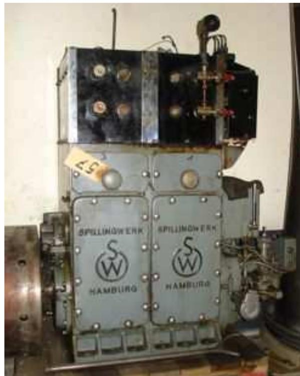
Die auf der Seite angebrachte Tafel zeigt neben Produktions- und Leistungsdaten bildlich, was unter einem Baukastenmotor zu verstehen ist. Ein weiterer Zylinderblock wird zusammengesetzt, herangeschoben und angebaut. So wird aus einem 2 ein 3-Zylinder-motor.
